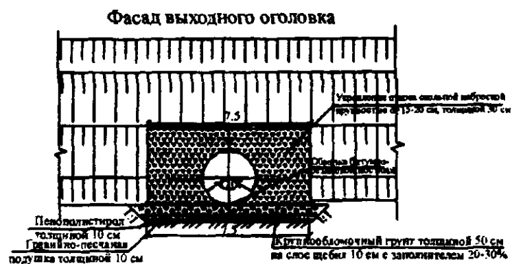
Рис. М.2. Пример проектирования армогрунтовой обоя, противофильтрационного экрана (геомембраны), входного и выходного оголовка и рассеивающего валика для МГТ на рис. М.1
